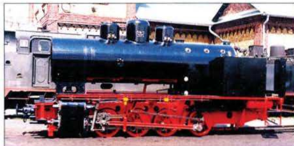
Am 24. April 1999 wurde der Kessel der Lok 20 wieder auf das aufgearbeitete Fahrwerk gesetzt.
