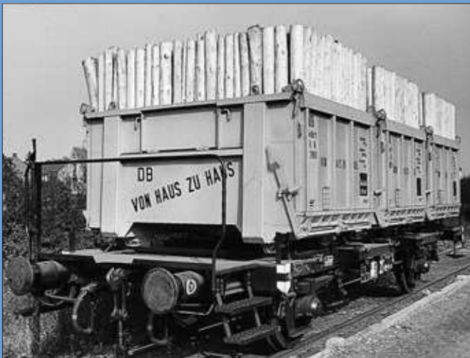
Ungewöhnliches Ladegut: offene Behälter Eoskrt mit Grubenholz auf einem Neubau-Tragwagen BTs 50. Foto: Archiv Michael Meinhold
