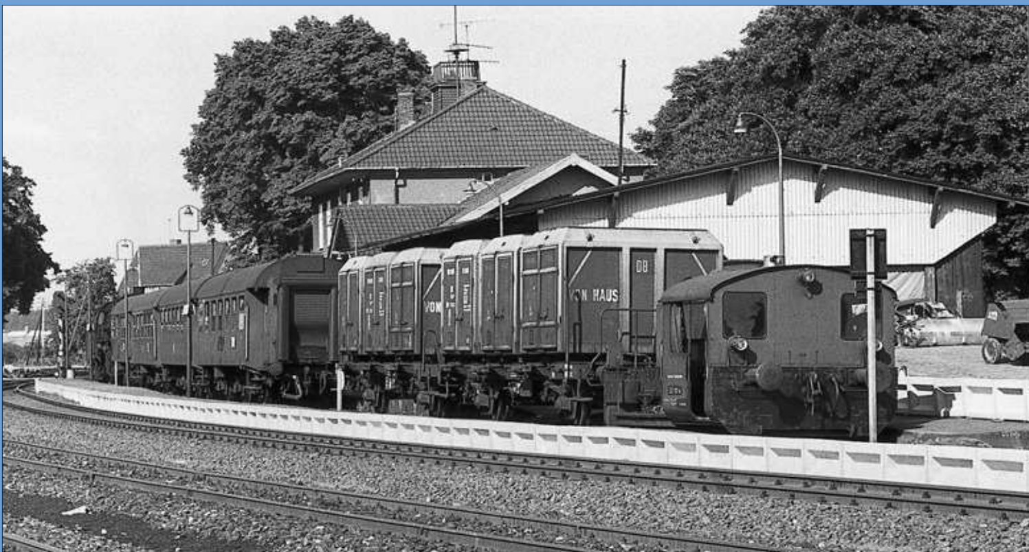
Ungewöhnliches Ladegut: offene Behälter Eoskrt mit Grubenholz auf einem Neubau-Tragwagen BTs 50. Foto: Archiv Michael Meinhold
