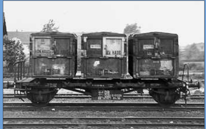
Der Tragwagen BTs 30 entstand durch Umbau zumeist kriegsbeschädigter Güterwagen (erkennbar am Sprengwerk); bemerkenswert ist die Verschmutzung der Behälter, die wie die „weathering“-Übung eines Anfängers wirkt (Bensheim, 30.4.1959). Foto: Joachim Claus
