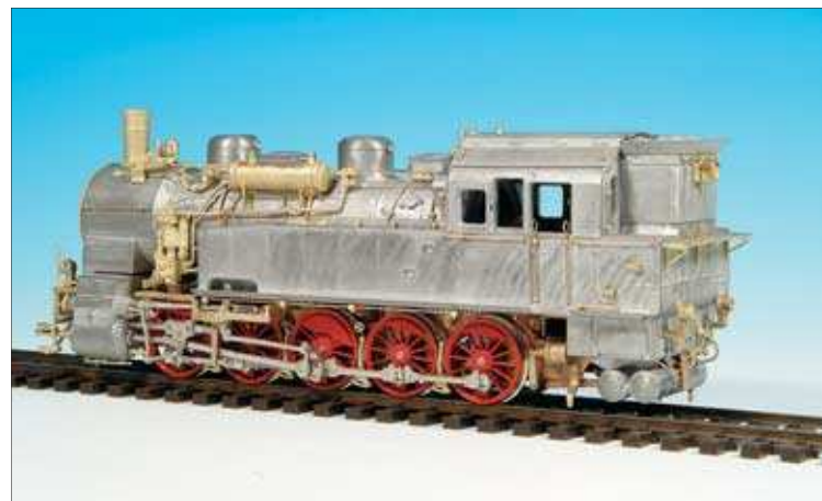
88 Ein exaktes Modell der 94.5 mit Riggerbach-Gegendruckbremse stellt die Weinert-Maschine dar, wenn die Bausatzteile zusammengebaut wurden. Martin Knaden hat sich der Preußin angenommen und gibt Tipps zum Gelingen. Foto: MK
