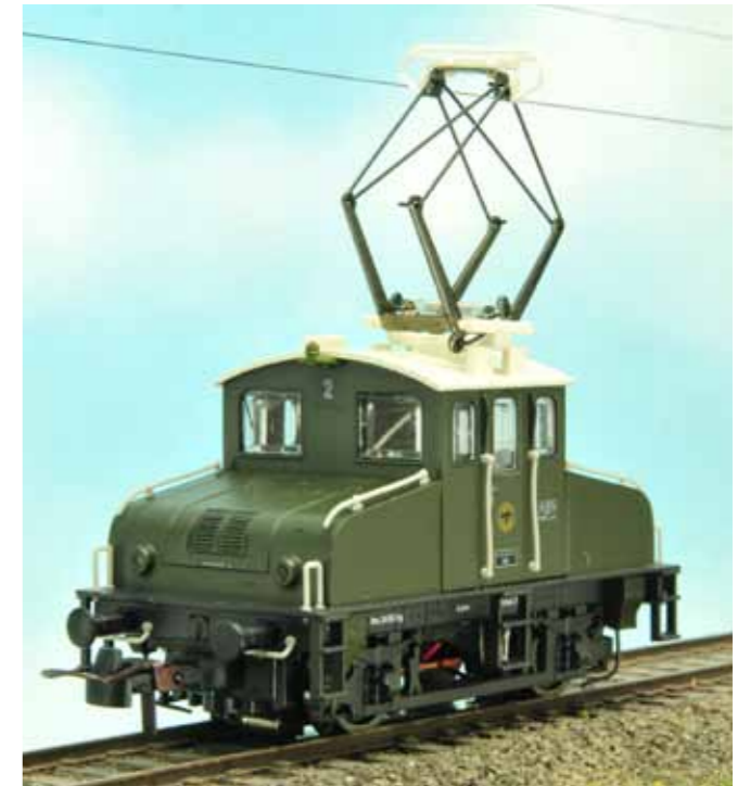
Leicht daneben: Wegen des asymmetrisch montierten Stromabnehmers ist die Dingler-Postlok auf normalen Oberleitungsanlagen nicht einsetzbar. Schade, denn der langsam laufende Schienenzweig wäre die ideale Rangier- oder Lokalbahnlok.
