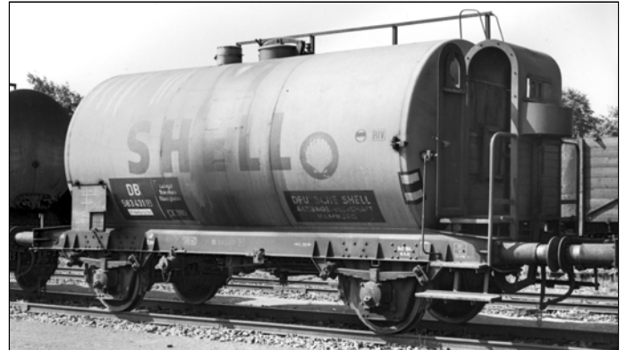
Der 1961/62 in Nürnberg Rbf aufgenommene 30-m 3 -Kesselwagen der Einheitsbauart 583 431 [P] zeigt, dass die Shell ihre Wagen z. T. bunt durcheinander einnummerte. (Foto Heinz Kühneth, Slg. HW)
