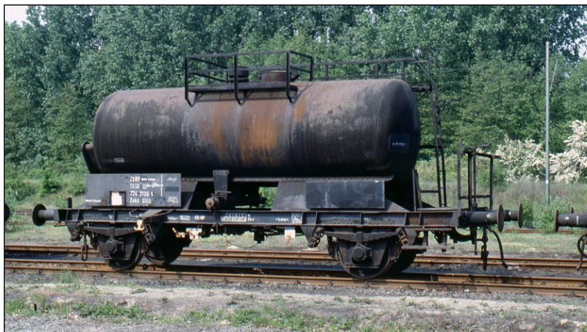
Der Zekk [7243] 724 3108 [P] der Nacco mit einem 9000-mm-Untergestell mit Doppelschakenlaufwerken, im Mai 1993 in Kirchweyhe fotografiert. Der Wagen hatte nachträglich Seilankerkonsolen erhalten, die Heizung war inzwischen ausgebaut.
