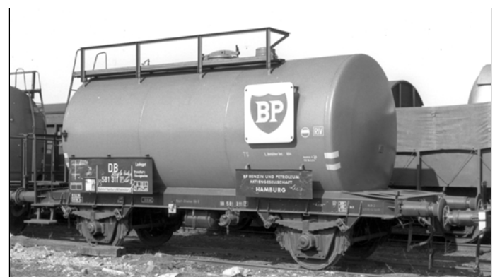
Der 581 311 [P] der BP hat vermutlich bei der Untersuchung am 9.9.64 außer dem neuen Anstrich auch Rollenlagerradsätze erhalten. (Foto Slg. SC)
