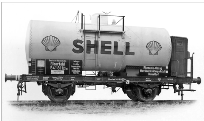
Gelbe Shell-Kesselwagen gab es bereits Ende der 20er-Jahre, wie dieses Foto belegt. Es zeigt den von Van der Zypen & Charlier am 26.6.28 an die Rhenania-Ossag Mineralölwerke Aktiengesellschaft Düsseldorf gelieferten Austauschbauwagen Elberfeld 541 811 [P] mit 24,6 m³ Kesselinhalt. (Werkfoto Van der Zypen & Charlier, Slg. HW).
