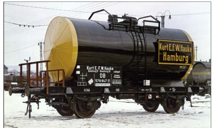
Der 579 647 [P], ein am 7.1.59 von Kaminski an Kurt E.F.W. Hauke in Hamburg gelieferter 25-m 3 -Heizölwagen mit seitlichen Aufstiegen, Heizung und Isolierung. (Werkfoto Kaminski, Slg. HW)
