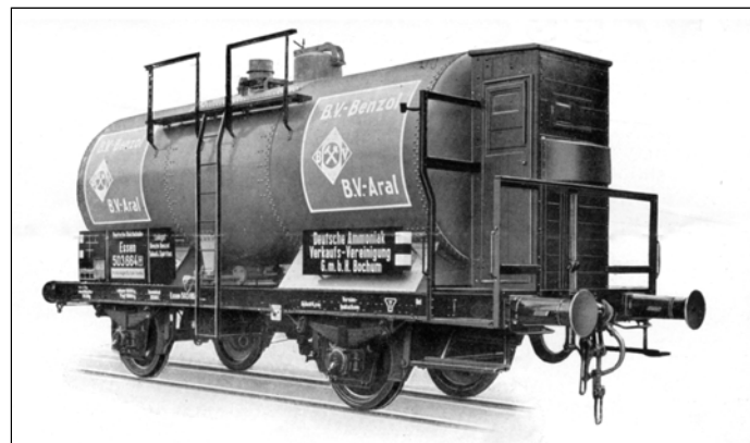
Und auch Kesselwagen mit großen blau-weißen B.-V.-Aral gab es schon in den 30er-Jahren. Einsteller des von Orenstein & Koppel gebauten 19,2-m³-Wagens Essen 503 664 [P] zum Transport von Benzin, Benzol, Toluol und Spiritus war die Deutsche Ammoniak Verkaufs-Vereinigung G.m.b.H. Bochum (Werkfoto O&K, Slg. Klaus Holl)
