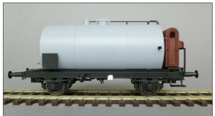
Der oben abgebildete Kesselwagen der Einheitsbauart erhielt nur die normalen Verfeinerungen – Federpuffer, Rangierergriffe, Bremsumstellhebel etc. (Modellbau und Foto Marc Heckmann), unten wurden darüber hinaus u. a. an das breite Untergestell angepasste neue Auslaufventile, (CN-Modell) und neue Achslager aus dem Bahnsinn@Shop montiert. (Modellbau und Foto Christoph von Neumann).
