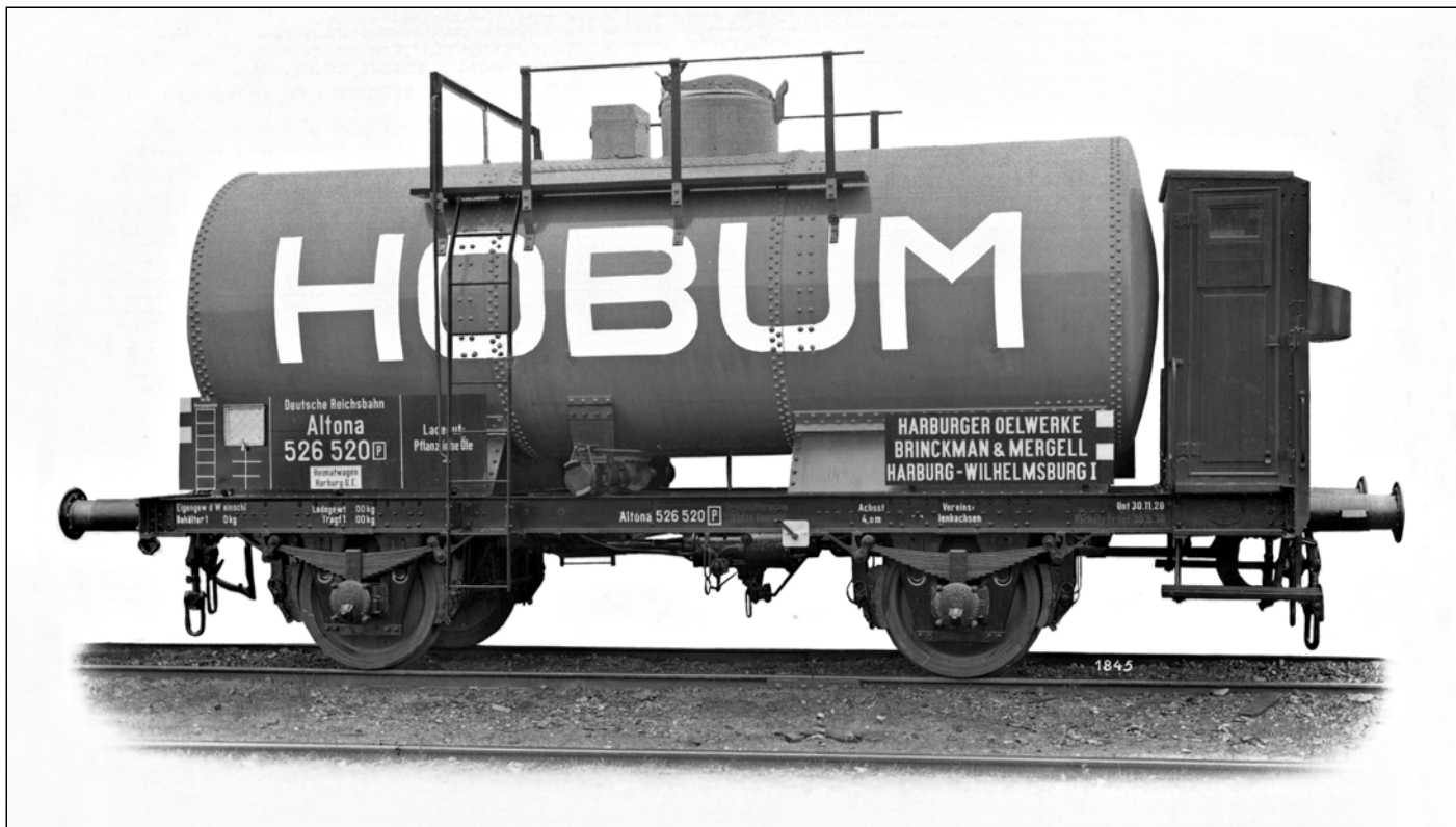
Der am 30.11.26 für die Harburger Oelwerke Brinckman & Mergell gebaute Altona 526 520 [P] zum Transport pflanzlicher Öle und Fette repräsentiert die frühe Form der 19,2-m 3 -Austauschbaukesselwagen mit genietetem Behälter. (Werkfoto Westwaggon, Slg. RWWA)
