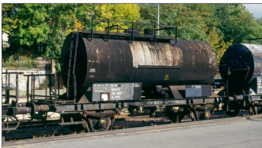
Der in Quedlinburg zuletzt im August 1989 untersuchte Ze [7098] 709 8607 [P] der KVG stand im September 1993 in Altenburg bereits „auf dem Rand“. Mit einem isolierten Kessel mit Heizung und einem 9000-mm-Untergestell mit KE-GP-Bremse war er ein typischer Vertreter seiner Bauart. (Fotos HW)
