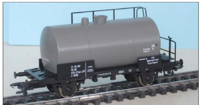
Der oben abgebildete Kesselwagen der Einheitsbauart erhielt nur die normalen Verfeinerungen – Federpuffer, Rangierergriffe, Bremsumstellhebel etc. (Modellbau und Foto Marc Heckmann), unten wurden darüber hinaus u. a. an das breite Untergestell angepasste neue Auslaufventile, (CN-Modell) und neue Achslager aus dem Bahnsinn@Shop montiert. (Modellbau und Foto Christoph von Neumann).
