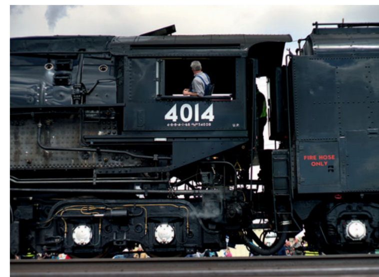
Blick auf den Heizerstand des Big Boy 4014. Bei dieser Aufnahme wird deutlich, dass es sich wirklich um einen „Big Boy“ handelt. Fünf Jahre dauerte übrigens die Aufarbeitung dieser 6500 PS starken Lokomotive, die über 50 Jahre in einem kalifornischen Eisenbahnmuseum gestanden hatte. Hendrik Bloem
