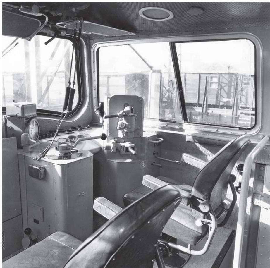
Ungewohnt für amerikanische Lokführer war die Anordnung der Anzeigen in der Art eines Armaturenbretts. Beachtenswert auch die Sonnenblenden, die man so auf vielen deutschen Loks finden konnte.
